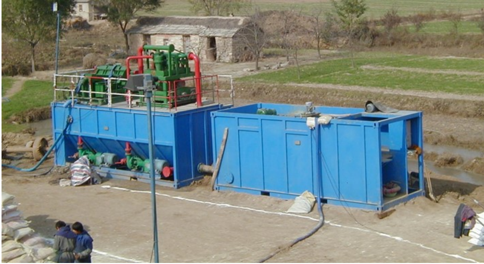
图 2-8 泥浆回收装置示意图
