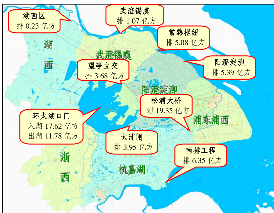
图 3.1 环太湖进出水量及主要工程排水示意图
