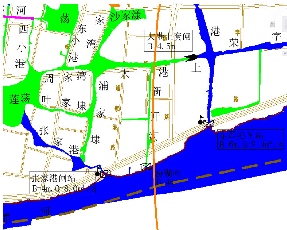
图 2.3-5 太浦河汾湖段北岸铁路隧道附近水利设施
